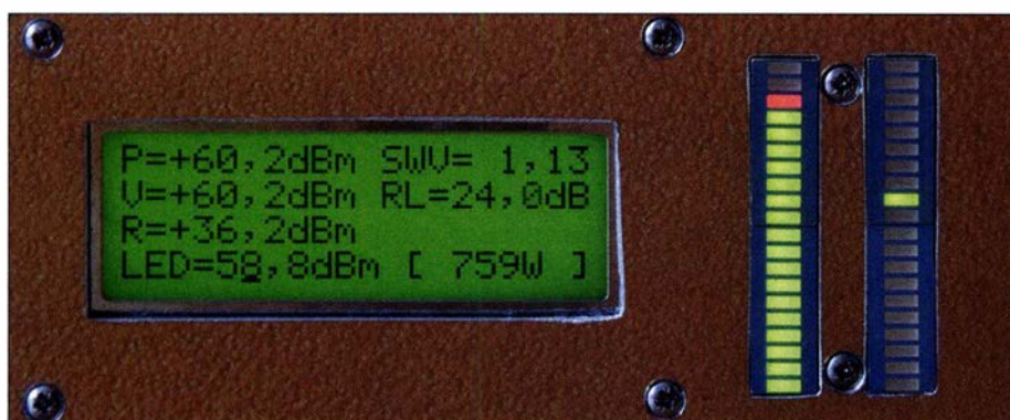
Bild 9: Hier liegen z. B. etwa 1 kW HF-Leistung am externen Messkopf an. Die Displaydarstellung erfolgt in Dezibel über 1 mW. Der Maximalwert für den grünen Anzeigebereich der linken LED-Zeile beträgt 58,8 dBm (entspricht 759 W). Die rechte LED-Zeile signalisiert die Höhe der Rückflussdämpfung.
