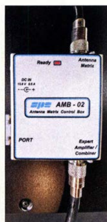
Passend zu den Expert-PAs von spe zeigte Reimesch für den ferngesteuerten Antennenumschalter AMB-01 diese Ansteuerbox AMB-02, die das Schaltsignal auf das Antennenkabel bringt.
