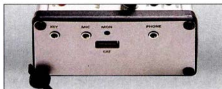
Auf der linken Seite befinden sich die Buchsen Key, Mic, Mon, Phone und CAT.
