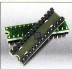
IO-Warrior28 im QFN-Gehäuse, aufgelötet auf DIL28-Module
