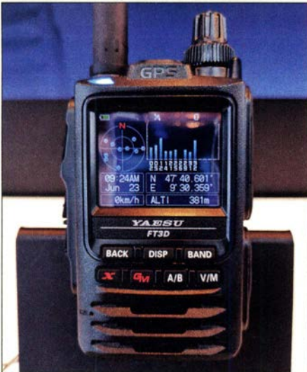
Das Yaesu-Spitzenmodell FT3DE für 2 m und 70 cm bedient FM und C4FM Fusion mit 5 W Sendeleistung, verfügt über GPS-Empfänger und hat zudem eine Bluetooth-Einheit an Bord – etwa für Freisprechen im Pkw.
