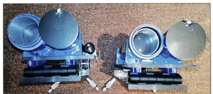
Bild 2: Frontansicht der beiden Lichtsprechgeräte mit geschlossenen Blenden an den Empfängerrohren und den Scharnieren zwischen Trägerplatte (oben) und Grundplatte (unten)
