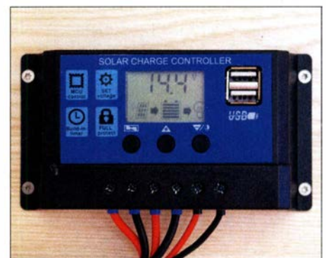
Bild 2: Der eingesetzte PWM-Solarladeregler ist einfach zu beschalten, sein aktueller Betriebszustand lässt sich auf einem übersichtlichen LC-Display ablesen.
