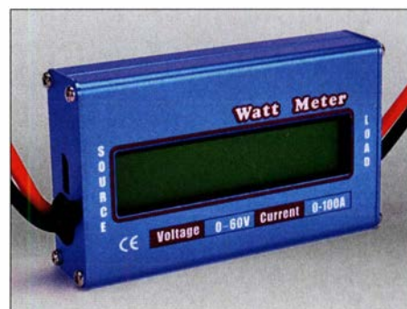
Als Messgerät kommt dieser Spannungs-, Strom- und Leistungsmesser zum Einsatz.
