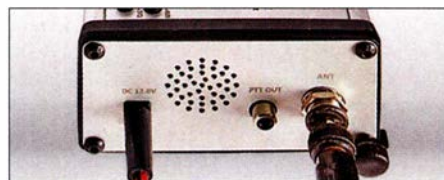
Rechts liegen die Buchsen für Stromversorgung, externe PA, Antenne und die Lautsprecheröffnung.
