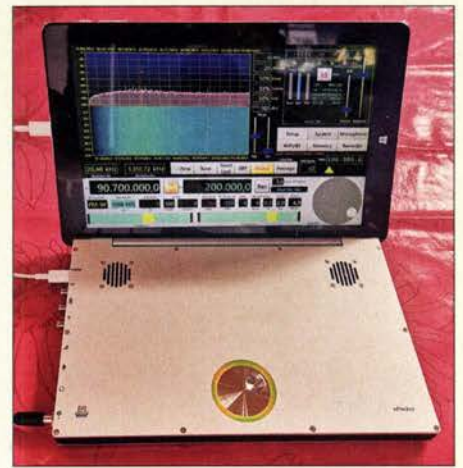
Der sPocket von Reuter ist ein konfigurierbarer KW-Receiver mit Optionen für UKW-Empfang und Transceiverbetrieb. Ein abnehmbares Tablet mit Touchscreen-Bedienung gestattet vielfältige Kombinationen.
