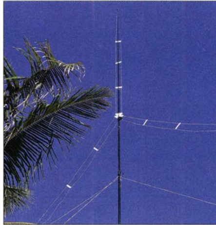
Eine unserer Groundplane-Antennen, hier die für 10 m bis 17 m, mit angehobenen Radials
