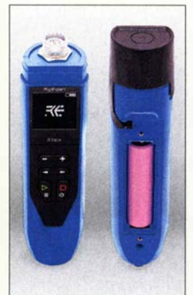
Bedienfeld und Display auf der Vorderseite und geöffnetes Batteriefach auf der Rückseite des Sticks
