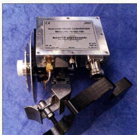
Der neue LNB für QO-100-Empfang von Kuhne Electronic, lässt sich, etwa wie hier kombiniert mit einem DJ7GP-Duoband-Feed von Bamatech, direkt an der LNB-Halterung eines handelsüblichen Offset-Spiegels befestigen.
